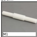
M1 Coppia ruota e vite senza fine, Plastica lavorata (delrin)
