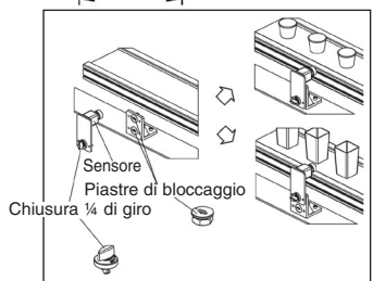
Esempio di applicazione: modifica della posizione del sensore
