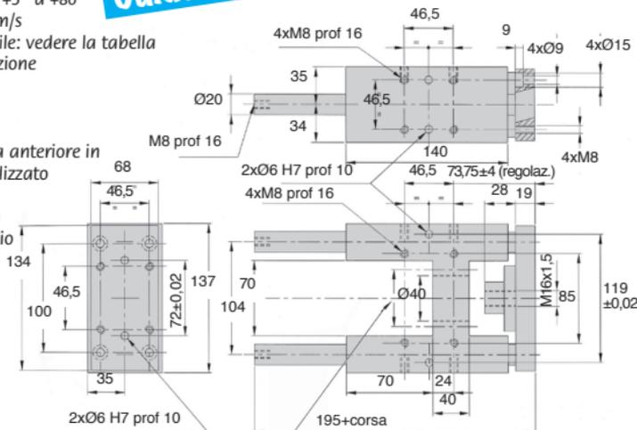
fissaggio del cilindro tramite 4 viti M8 su Ø46,5
