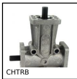
CHTRB Riduttore a rinvio angolare a L o a T, fino a 53,1 Nm
