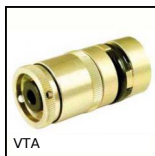
VTA Limitatore di coppia ad attrito Vari-Tork®, 0.53 a 1.32 Nm
