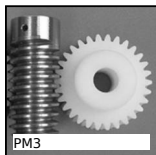
Coppia ruota e vite senza fine, Plastica lavorata (delrin)
