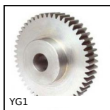
YG1 Ingranaggio dritto PRESTAZIONE, Acciaio 35NCD6
