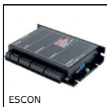
ESCON Variatore di velocità 5A, 5 A
