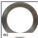
IN1 Ingranaggio interno, Acciaio 20NCD2
