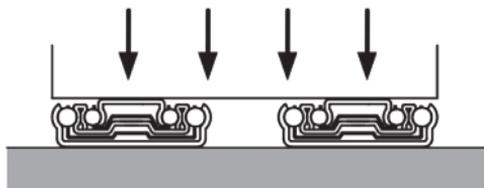
Il montaggio orizzontale è possibile ma è poco consigliato. I valori di carico sono molto inferiori rispetto ai binari di guida montati verticalmente.
