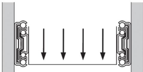
Il montaggio verticale di taglio è caratterizzato da file di sfere sovrapposte, è molto resistente alla deformazione e aumenta la durata di vita nonché la resistenza dei binari di guida.
