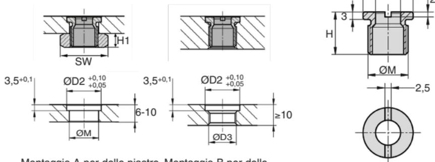
Montaggio A per delle piastre di uno spessore di 10mm.
