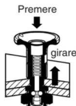
Per rimuovere, tenendo il pulsante premuto, estrarre il perno di bloccaggio dalla bussola di fissaggio.
