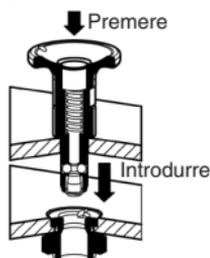
Tenendo premuto il pulsante, inserire il perno di bloccaggio nella bussola di fissaggio.
