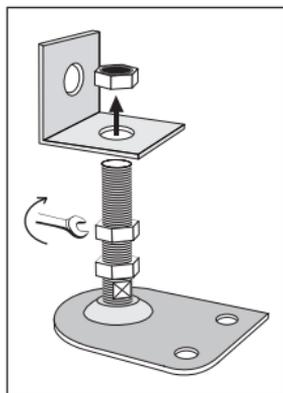
Régler la hauteur du pied à l'aide d'un écrou / contre écrou (non fourni)
