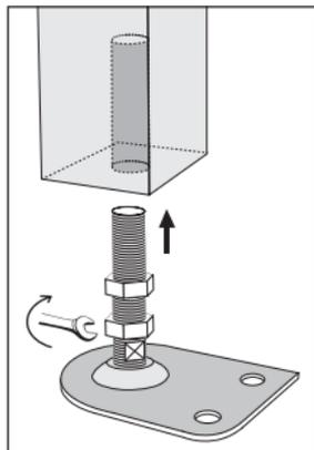
Insérer la vis dans le trou borgne en vissant à l'aide du méplat jusqu'à la hauteur désirée
