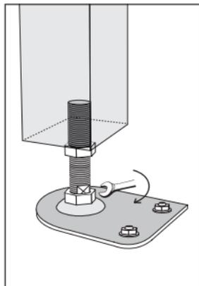
A la fin de la mise à niveau, serrer l'écrou sur l'embase afin de bloquer la tige en position angulaire
